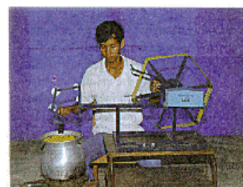
เครื่องสาวไหมแบบปรับปรุง โดยใช้แรงคน
